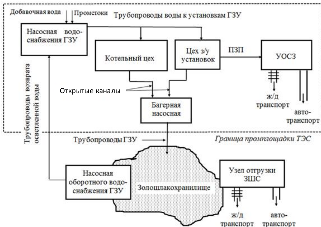
Рисунок 2.15 — Блок-схема комбинированной системы ЗШУ с отгрузкой потребителям сухой золы из УОСЗ и ЗШС из ЗШХ
